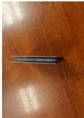
Diviseur thermique : Système composé de 2 plaques de métal avec une matière plastique entre les deux afin qu'il n'y ait pas de conduction thermique entre le radiateur et le cache-radiateur.
